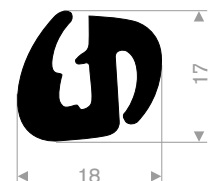
212.00.088 EPDM 70° Shore black roll length 30 meter
