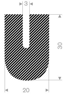
221.01.503 EPDM 15° Shore black roll length 25 meter
