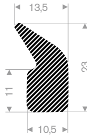
225.00.640 EPDM 15° Shore black roll length 50 meter
