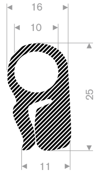
225.00.083 EPDM 15° Shore black roll length 30 meter
